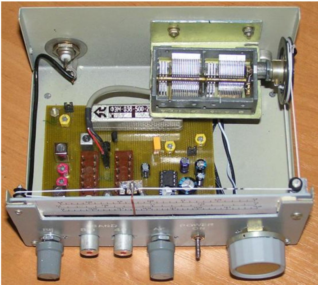
Рис. 2.7. Простой трёхдиапазонный приёмник радилюбителя-наблюдателя на 20, 40 и 80 м.
